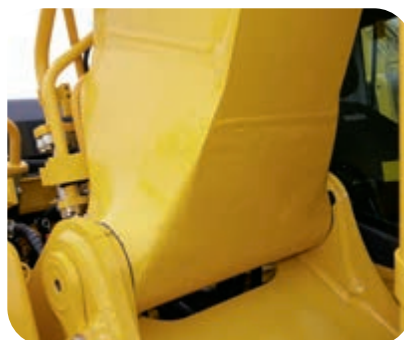
Pied de flèche en acier moulé et plaques de dessous de flèche d'une seule pièce
