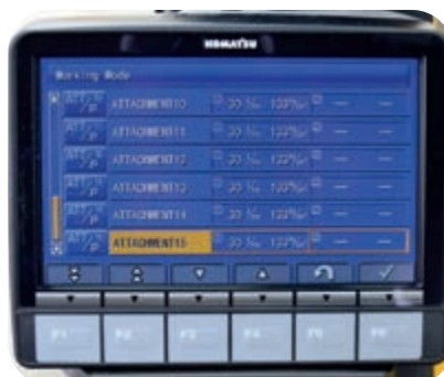
Contrôle des équipements intégré Komatsu (KIAC) offre jusqu'à 15 présélections d'outils pour le débit et la pression d'huile
