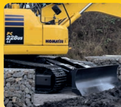
Lame (en option) pour patins acier triple arête et patins road liner (caoutchouc) de 600 mm
