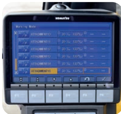
Le contrôle des accessoires intégré Komatsu (KIAC) offre jusqu'à 15 présélections d'outils pour le débit et la pression d'huile (en option)
