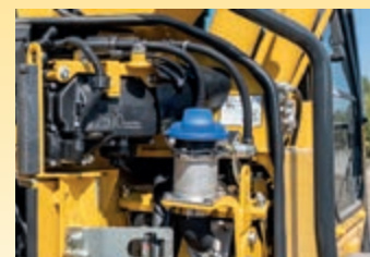
Pour faciliter l'accès au réservoir d'AdBlue®, celui-ci est installé sur l'escalier avant.
