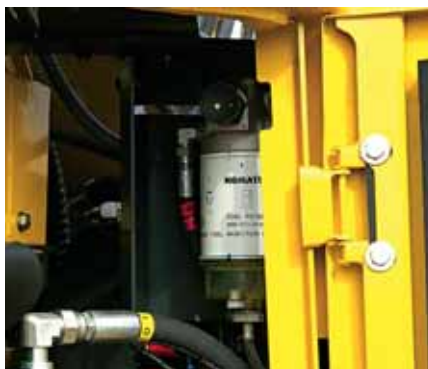
Le préfiltre à carburant avec séparateur d'eau
